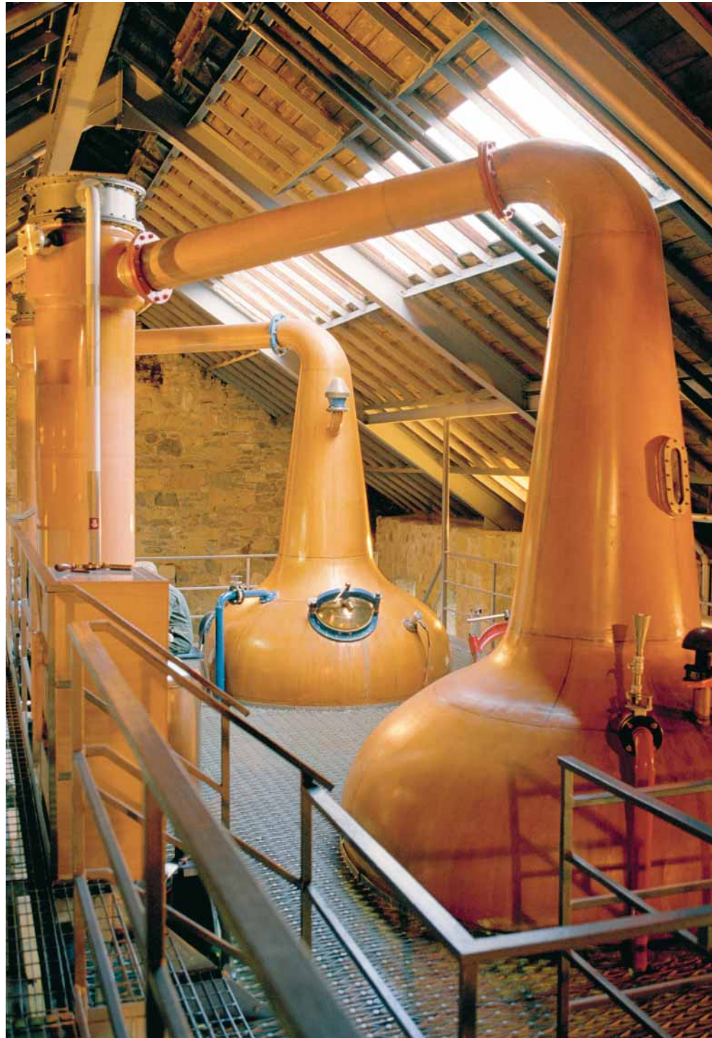
Ju mindre kopparpannor, desto bättre kvalitet på whiskyn. I pannorna upphetas den jästa vörten till strax under kokpunkten – vattnet blir kvar medan alkoholen förångas.
